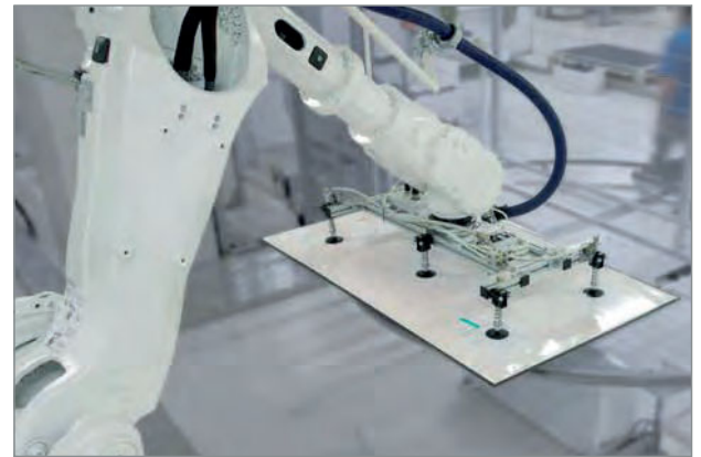
扁平真空吸盘PFTN搬运加工完成的塑料板材
