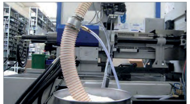
输送型真空发生器SEC应用于输送塑料颗粒物
